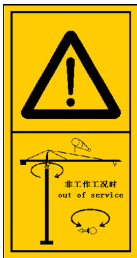
非工作工况时回转自由 Slewing freely out of service
